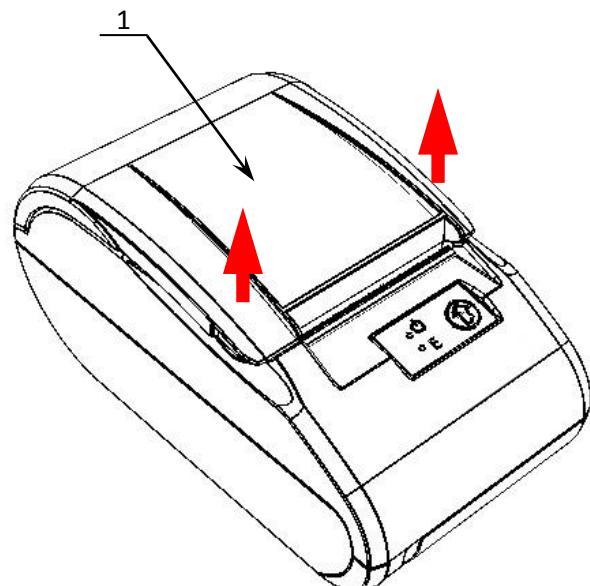
Рисунок 7. Места приложения усилий при открытии крышки
