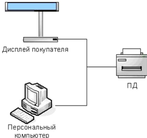
Рисунок 4. Подключение внешних устройств к ПД
