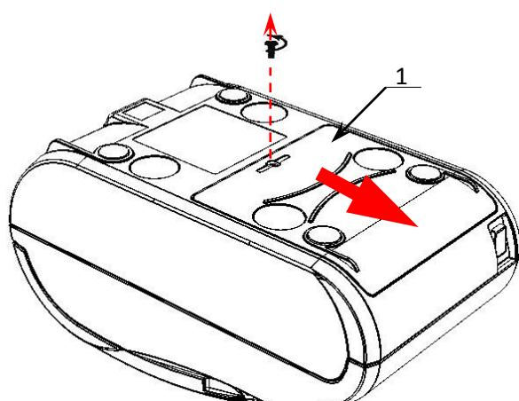
1. Открутить винт, который крепит крышку **1** отсека для АКБ к нижней части корпуса ПД.
