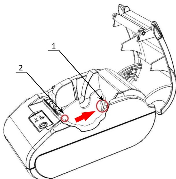
Рисунок 12. Направление приложения усилий при извлечении ограничителя ЧЛ
