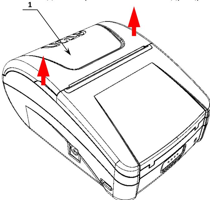
Рисунок 8. Места приложения усилий при открытии крышки
