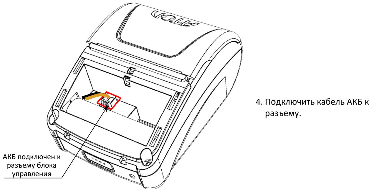
Рисунок 5. АКБ в отсеке для АКБ и ФН, подключен к разъему
