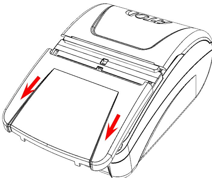
1. Сдвинуть крышку отсека для ФН и АКБ в направлении, показанном на рисунке.
