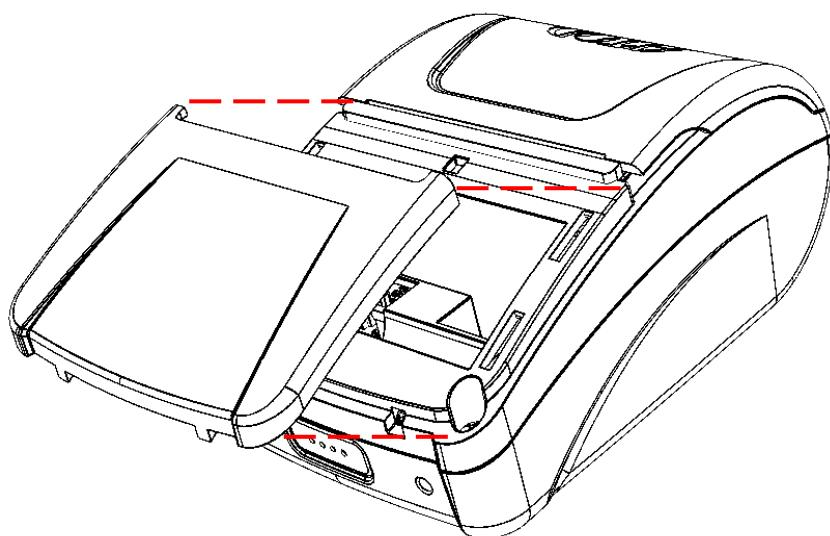
2. Отделить крышку отсека, аккуратно освободив фиксаторы из пазов.
