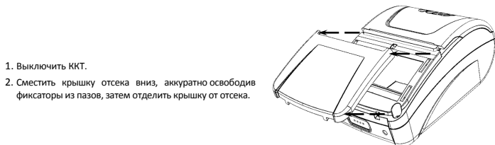
Рисунок 2. Крышка отсека для ФН и АКБ отделена от корпуса ККТ
